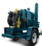
SLUDGE PRO® MOBILE BOMBAS DE DOBLE DISCO Bombas de aguas residuales portátiles accionadas por motor Tamaños: 3", 4", 6" (76mm, 102mm, 150mm) Máxima capacidad: 371 GPM (23 lps) Máxima cabeza: 115' (35 m) Máximo de sólidos: 1 3/4" (44 mm) Opciones: motores diésel finales Tier 4, remolques y paquetes en Skid.
