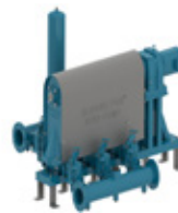
SLUDGE PRO® BOMBAS DE DISCO TRIPLEX Severe Duty Sludge Pumps Tamaños: 6" (150mm) Máxima capacidad: 375 GPM (24 lps) Máxima cabeza: 184' (56 m) Máximo de sólidos: 1 3/4" (44 mm)
