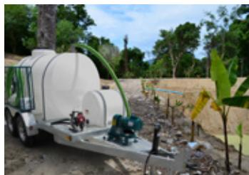
Réservoirs de déchets + eau avec pompes séparées
